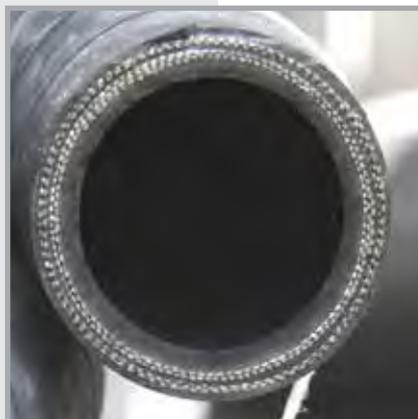
Шланг от компании Putzmeister армирован 4 тканевыми слоями и одним медным. Толщина стенки составляет 9 мм.
