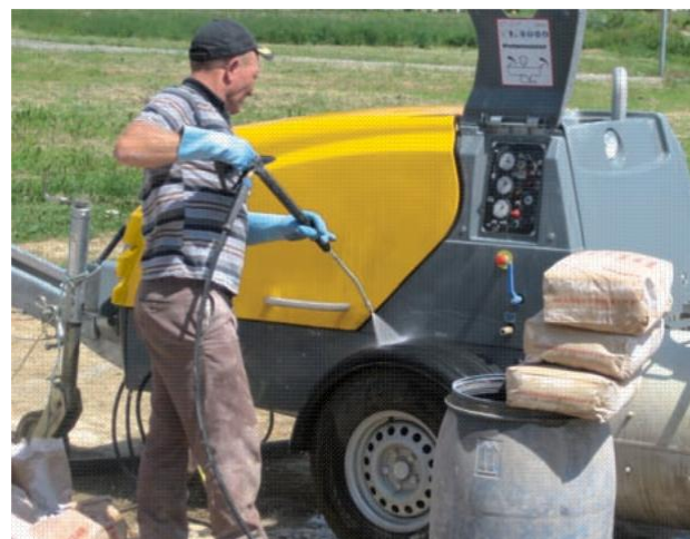
Опционально Миксокрет может быть оборудован мощным очистителем высокого давления.
