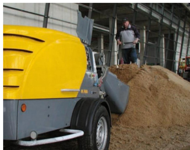
Новый Миксокрет - вариант со скипом и скраппером.
