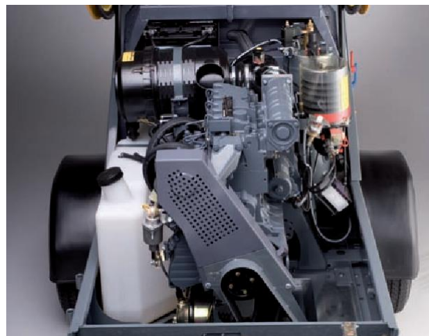
Новый дизельный двигатель располагается продольно с компрессором. Благодаря этому все легко доступно для обслуживания.
